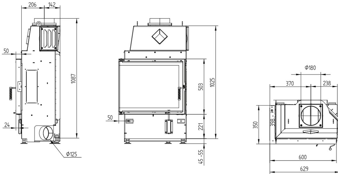
ECKA 60/35/50SL schmalere Einbautiefe links klappbar S-Aufsatzspeicher
