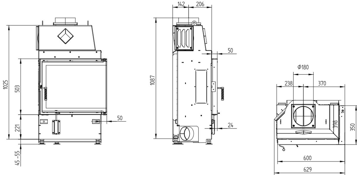
ECKA 60/35/50SR schmalere Einbautiefe rechts klappbar S-Aufsatzspeicher
