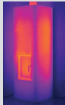
12 hod. od zakúrenia ~ teplota povrchu 45 °C
